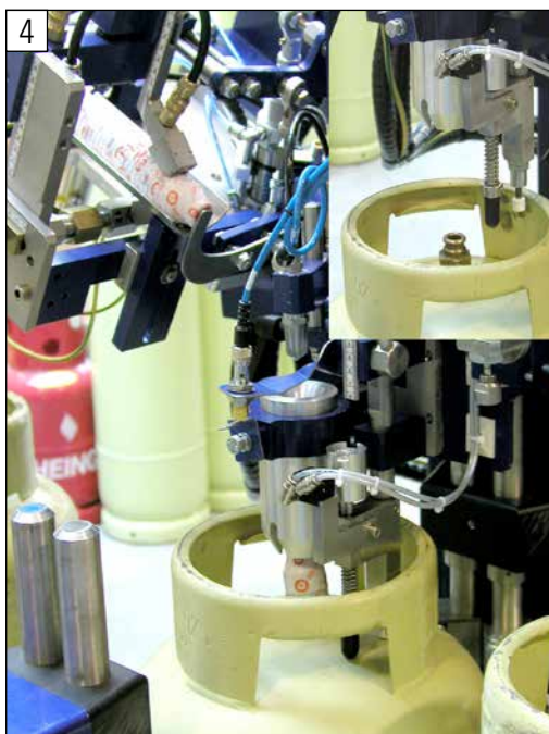
Aplicador de capsulas automático
