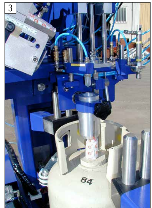
Aplicador de capsulas automático
