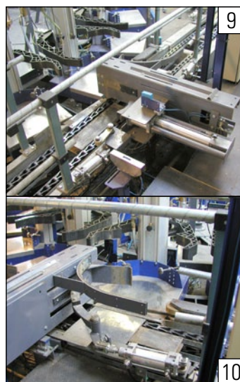
Arriba: Dispositivo de entrada tangencial TIE Abajo: Dispositivo de salida tangencial TIE
