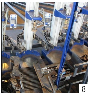
Entrada radial y salida tangencial con empujador de cilindros en cada llenadora
