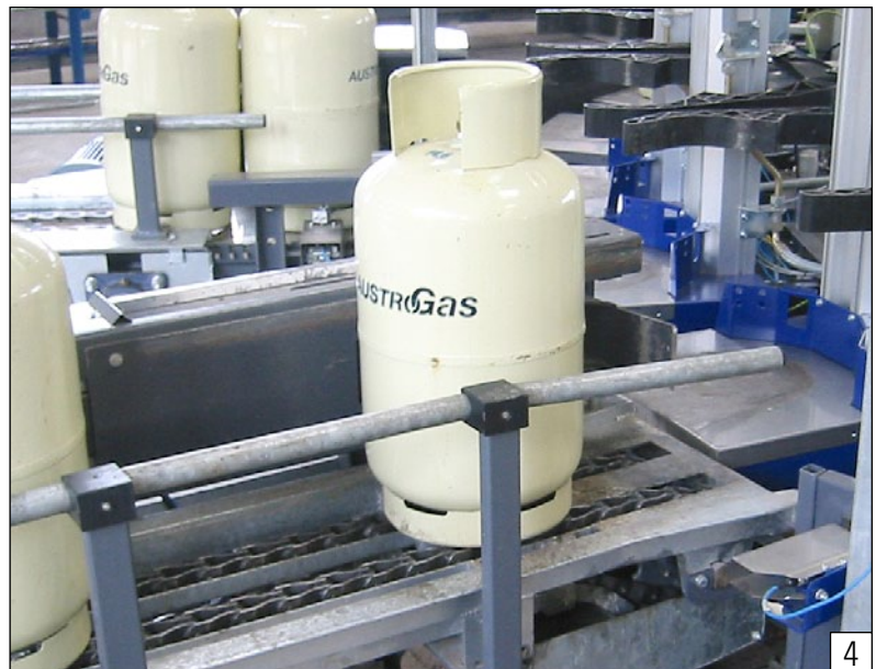
Dispositivo de salida PER para salida radial de los cilindros del carrusel de llenado
