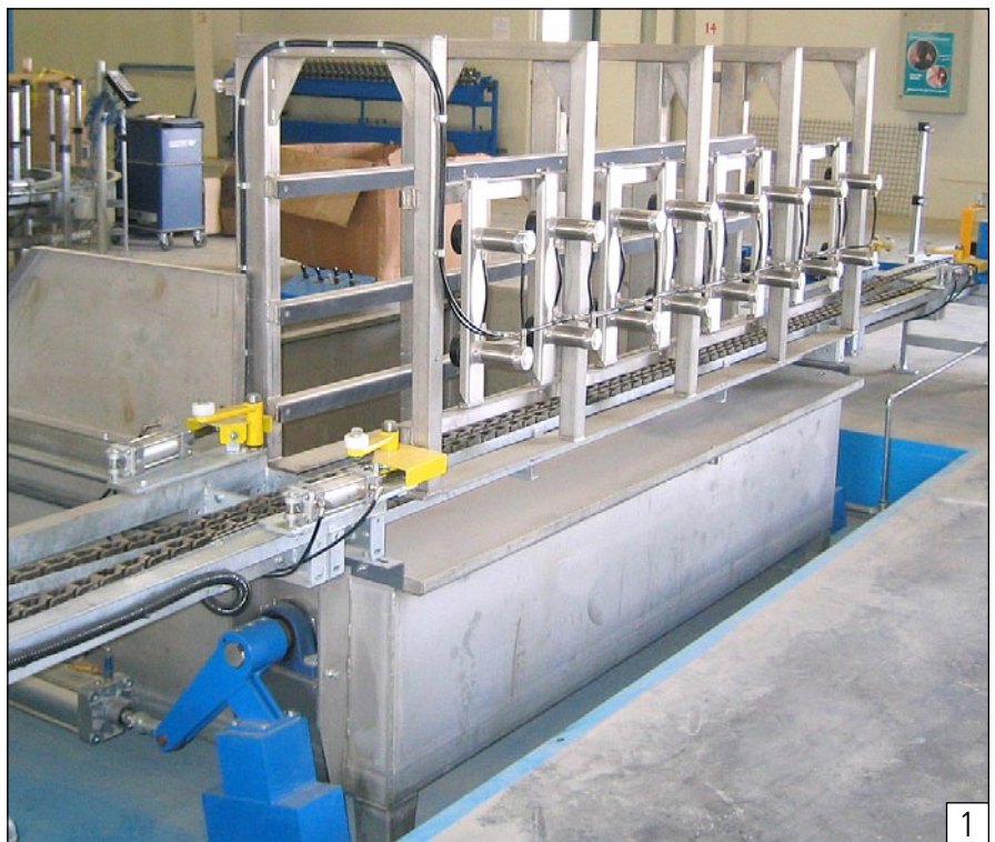
Equipo semiautomático EB-8 para prueba de hermeticidad integrado en transportador de cadena con rechazo de cilindros con fugas
