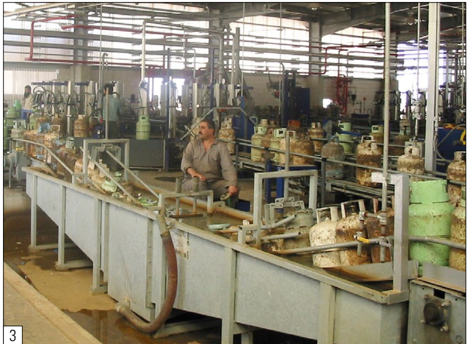
Equipo PCD para prueba de hermeticidad integrado en transportador de cadena
