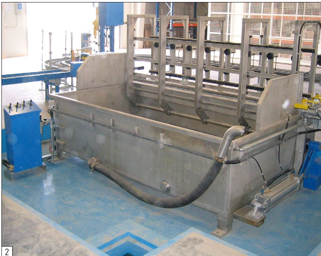
Equipo semiautomático EB-8 para prueba de hermeticidad integrado en transportador de cadena con rechazo de cilindros con fugas
