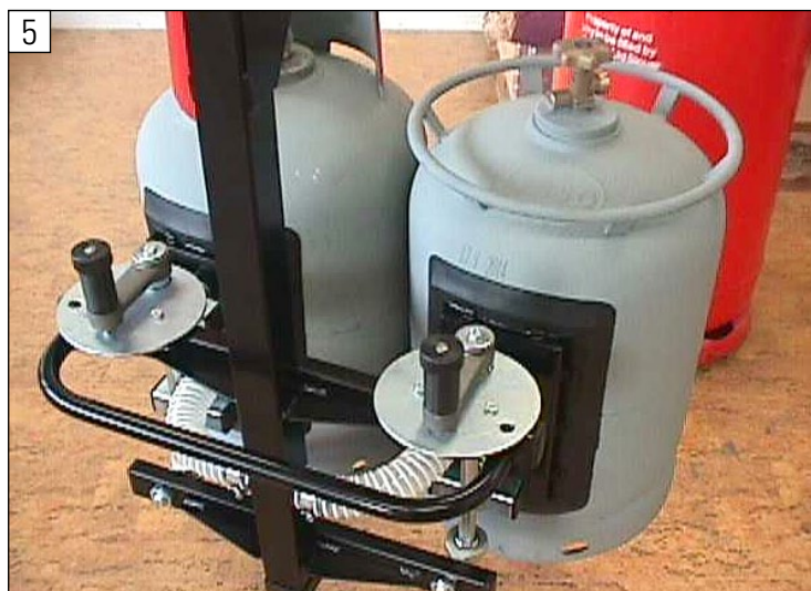
Sistema de manejo basado en el principio de vacío para dos cilindros
