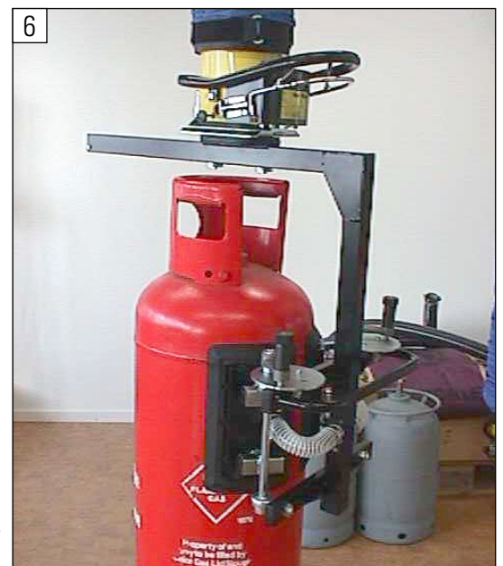
Sistema de manejo basado en el principio de vacío para un cilindro
