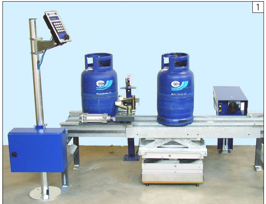
Sistema automático ECS de control del peso de los cilindros GLP para instalación en línea en el transportador de cadena
