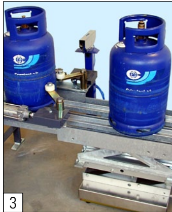
3 Vista detallada de parada de acumulación en transportador de cadena (incluso fotocélula), balanza inferior y mesa elevadora
