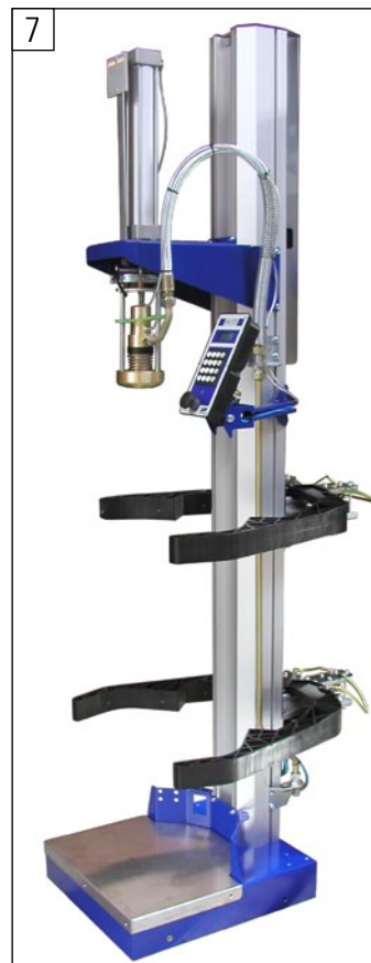
Llenadora universal UFM con dispositivo de centrado doble para llenado automático de cilindros industriales con válvulas de centro
