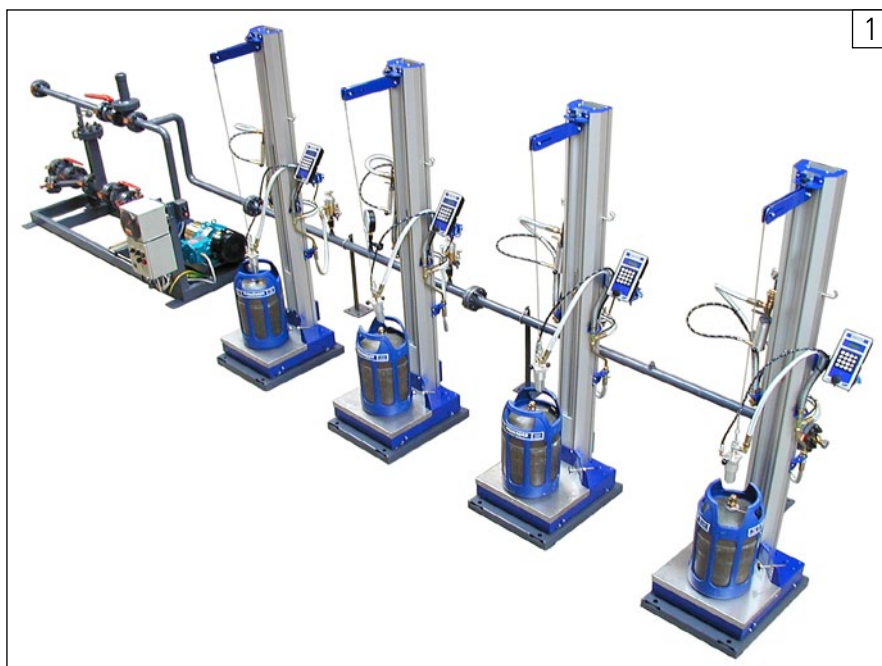
Unidad de llenado operada por un solo hombre con 4 llenadoras universales UFM y plataforma completa con bomba GLP, panel de alimentación para zona de peligro y arreglo de tubería (incluso filtro, válvula de presión diferencial y sensor del nivel de líquido)
