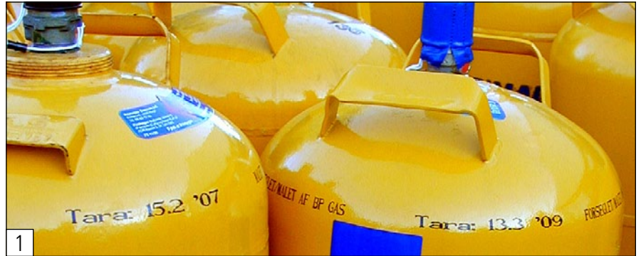
Ejemplo de datos de cilindro imprimidos a inyección de tinta como texto claro
