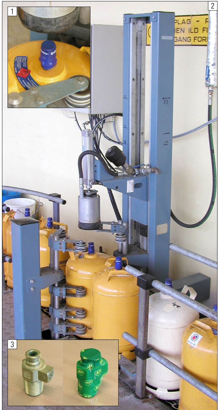
La termoselladora SMS automática, que encoge los sellos por medio de vapor de agua, está diseñada para instalación en el transportador de cadena
