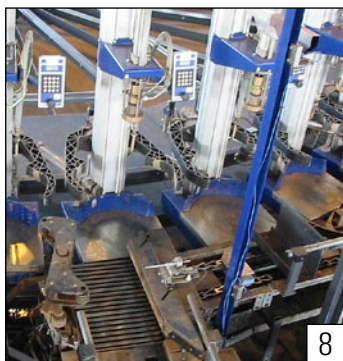
Dispositif d'admission radial combiné avec dispositif d'éjection tangentielle avec poussoir de bouteilles installé sur chaque machine d'emplissage
