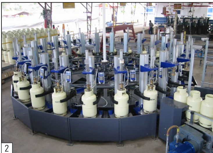
Système d'emplissage sur carrousel avec machines d'emplissage électroniques UFM
