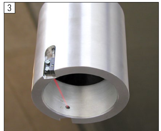
La tête d'orientation est mise dans une position où elle couvre le robinet et la bouteille est tournée. Quand le robinet arrive à la position correcte à l'intérieur de la tête d'orientation, un rayon à fibres optiques (illustré sur la photo comme un rayon rouge) est coupé, et la bouteille arrête de tourner.
