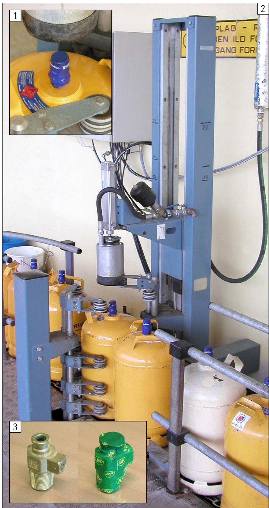
La machine à rétracter SMS entièrement automatique, qui rétrécit par moyen de vapeur d'eau, est conçue pour installation dans un convoyeur à chaîne
