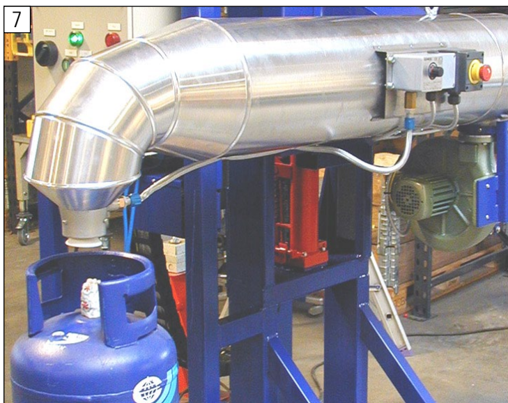
La machine de rétraction SMA, qui rétrécit par moyen d'air chaud, est conçue pour installation dans un convoyeur à chaîne
