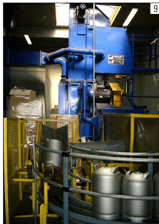
Equipement de grenailage avec chargement et déchargement automatique de bouteilles
