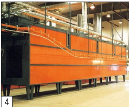
Four tunnel pour séchage après traitement préparatoire, durcissement/séchage de peinture humide ou durcissement de peinture en poudre
