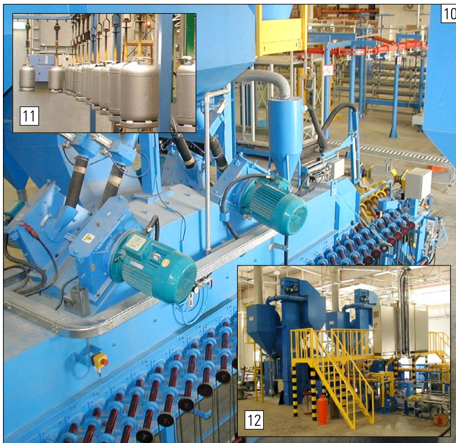
Equipement de grenailage avec chargement et déchargement automatique de bouteilles
