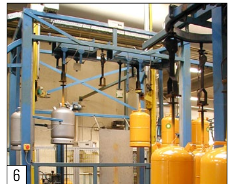
Transfert automatique de bouteilles depuis système de convoyeur à chaîne vers système de convoyeur aérien
