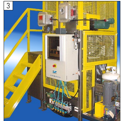
Equipement d'application de manchons pour tout le corps des bouteilles
