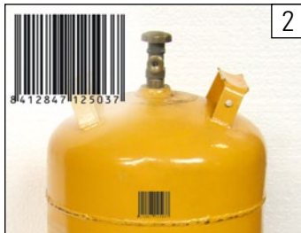
Exemple d'un code à barres imprimé au jet d'encre
