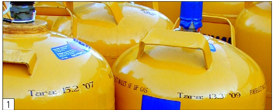
Exemple de données de bouteille imprimées au jet d'encre comme texte lisible
