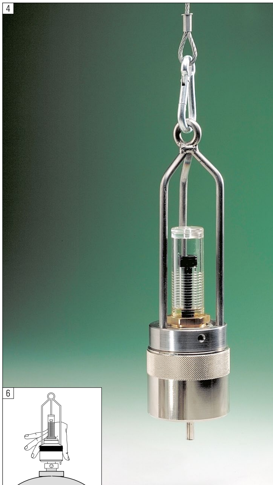
Détecteur de fuites TCV à commande manuelle
