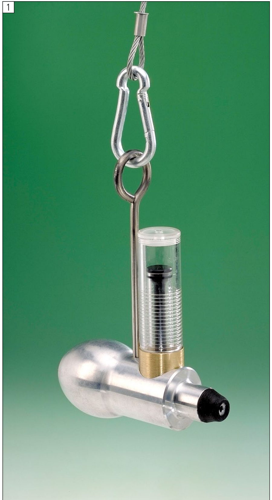
Détecteur de fuites TSV à commande manuelle
