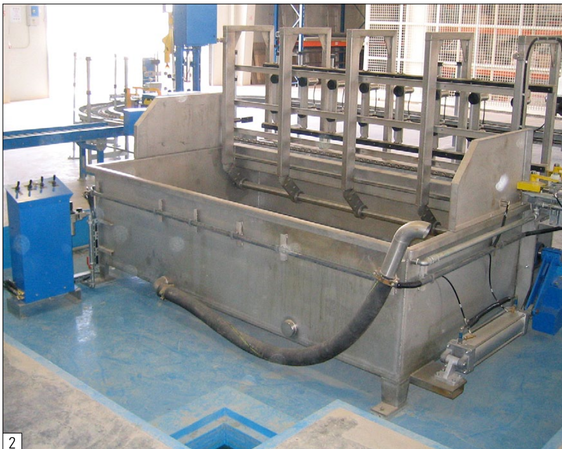
Bain d'essai d'étanchéité pneumatique semi-automatique EB-8 intégré en convoyeur à chaîne avec déchargement de bouteilles non étanches
