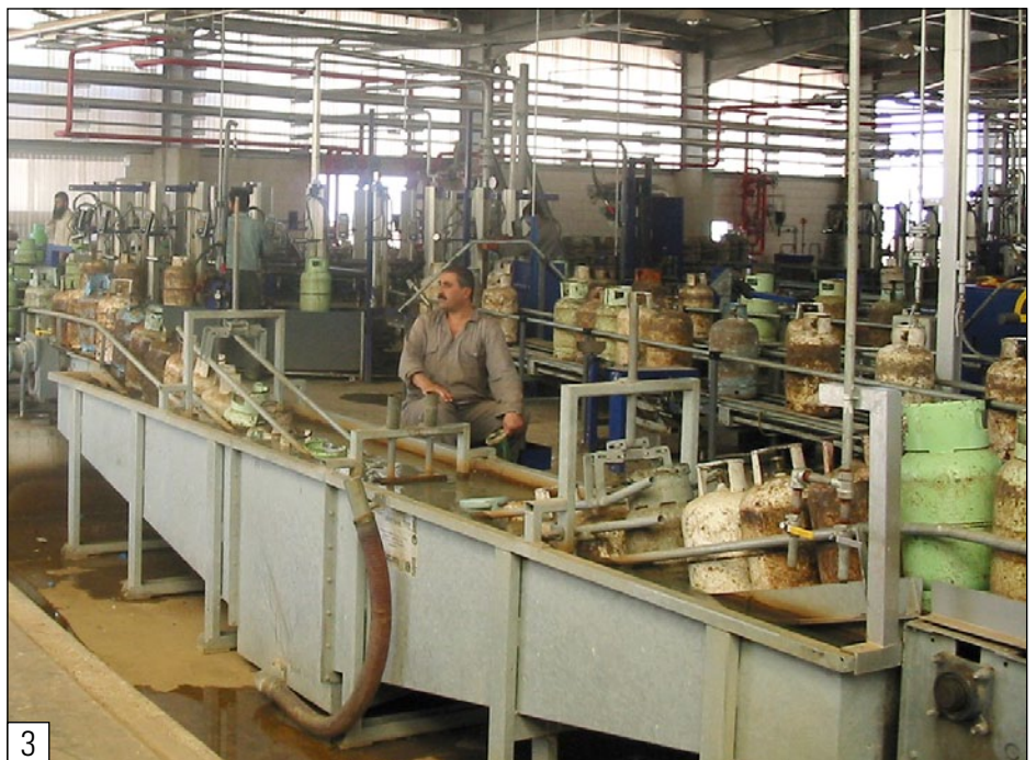
Bain d'essai d'étanchéité PCD intégré en convoyeur à chaîne
