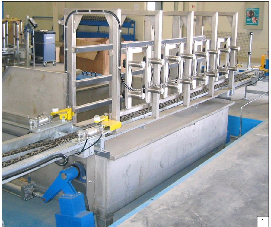
Bain d'essai d'étanchéité pneumatique semi-automatique EB-8 intégré en convoyeur à chaîne avec déchargement de bouteilles non étanches
