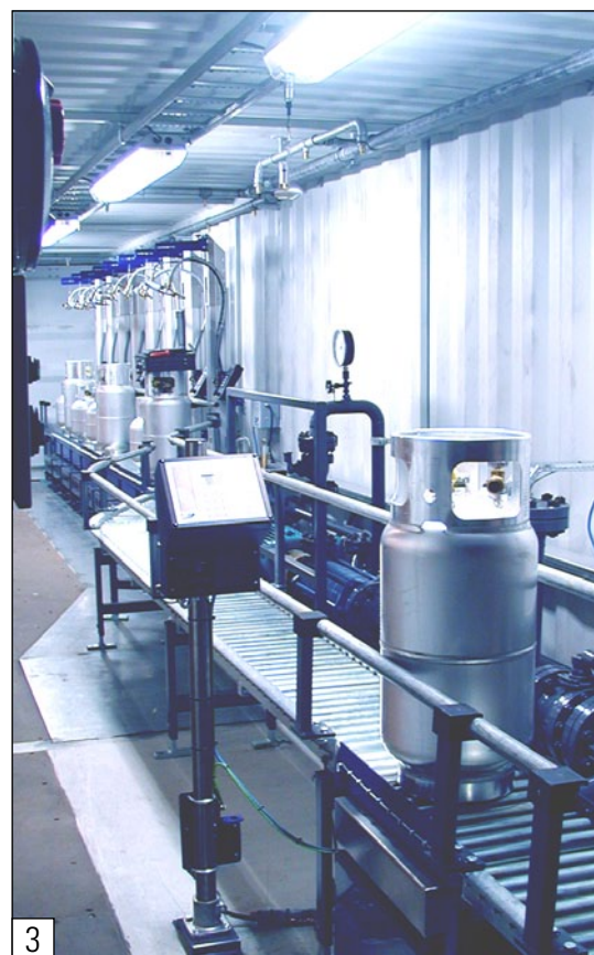
3 Système d'emplissage en ligne avec convoyeur à rouleaux
