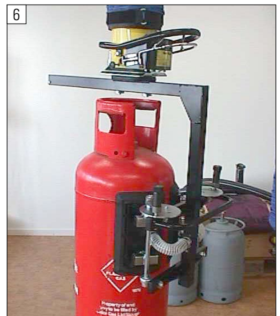
Système de manutention, basé sur le principe sous vide, pour une bouteille
