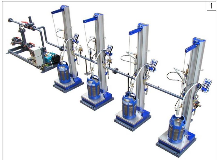
Ensemble d'emplissage opéré par un seul homme avec quatre machines d'emplissage universelles UFM et plate-forme complète munie d'une unité de pompe GPL, d'un tableau de puissance antidéflagrant et d'une tuyauterie (y inclus filtre, vanne de pression différentielle et indicateur de niveau de liquide GPL)
