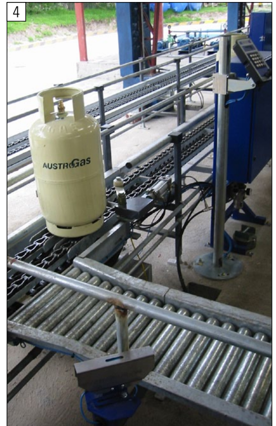
4 Système de pesage de contrôle ECS entièrement automatique installé en ligne sur convoyeur à chaîne avec convoyeur à rouleaux pour éjection des bouteilles remplies incorrectement
